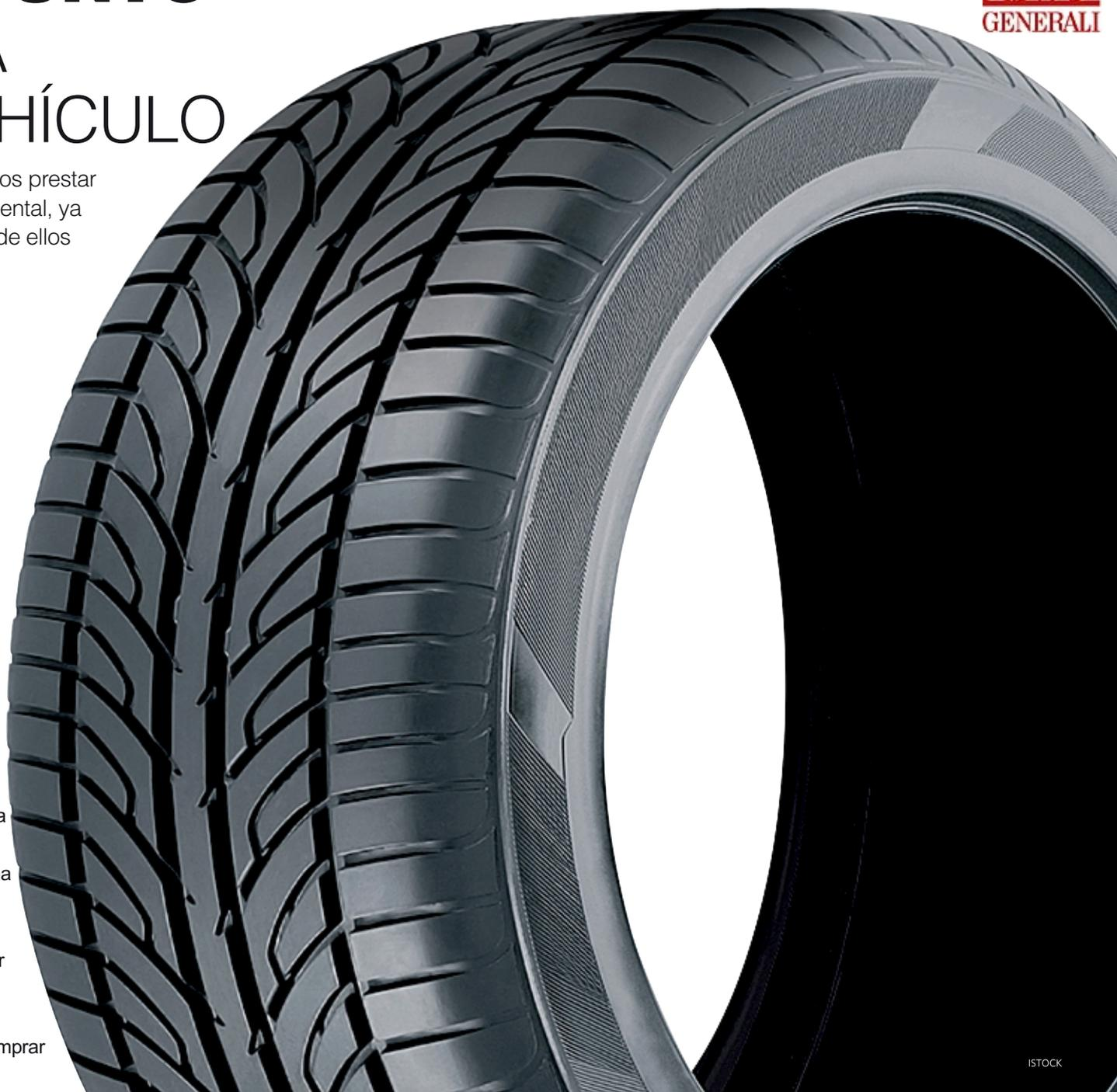
neumáticos nuevos tendremos que conocer ese valor, pero ¿qué significa el resto? En el caso del ejemplo, 85V, el número indica el índice de carga, que significa que ese valor tiene una correspondencia en una tabla que nos dice los kilos de peso máximo que puede soportar el neumático. Si lo multiplicamos por dos tendremos el peso total que soportarían para un eje, y éste es un valor importante si pensamos llevar bastante peso en nuestro vehículo.
